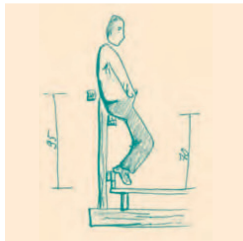
Schéma 18. Une "miséricorde" : schéma de principe.
