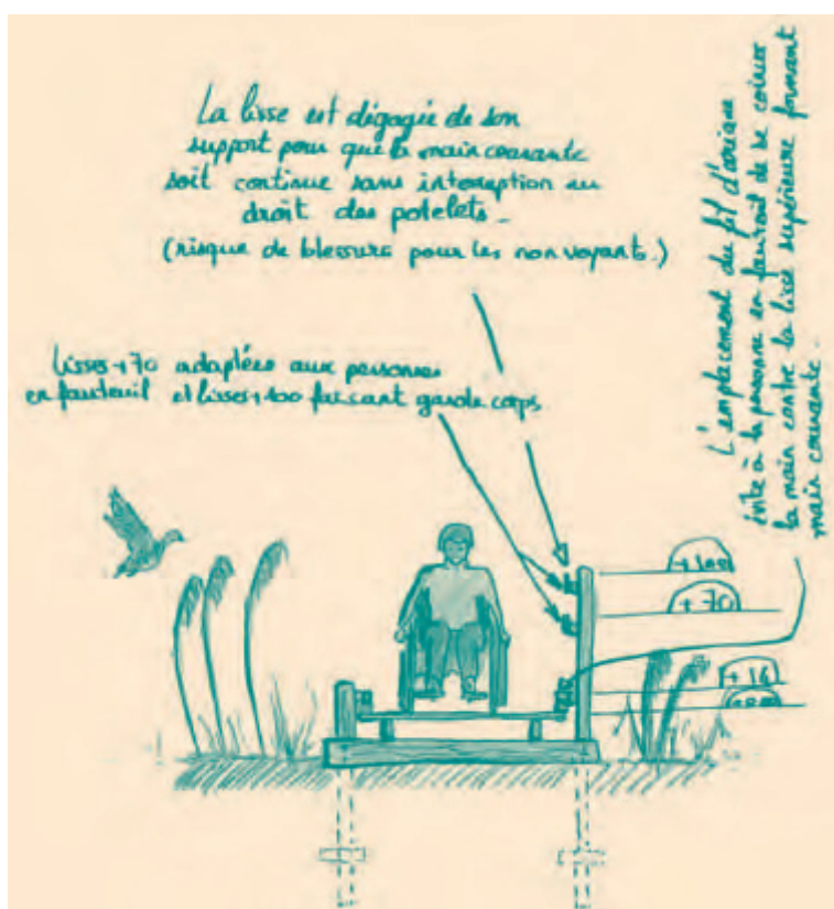
Schéma 3. Platelage 1,60 m avec lisses, dans le cas de chemin surélevé à plus de 30 cm
