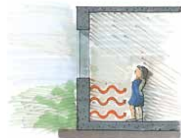
▲ RAYONNEMENT. La chaleur se transmet par ondes depuis des corps chauffés (plancher chauffant, poêle de masse)
