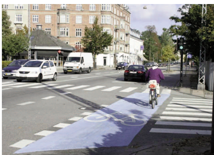
Danemark : bande cyclable délimitée par marquage au sol, utilisation de la couleur bleue en intersection afin de renforcer l'attention du conducteur
