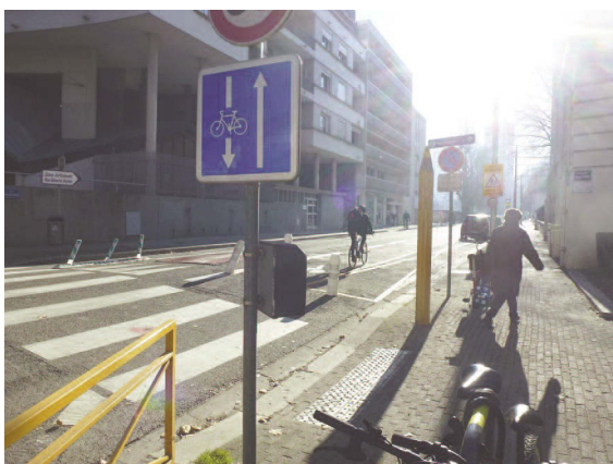
Entrée du sens de la circulation générale avec limitation ponctuelle à 30 km/h devant l'école (présence d'un coussin puis d'un ralentisseur trapézoïdal)
