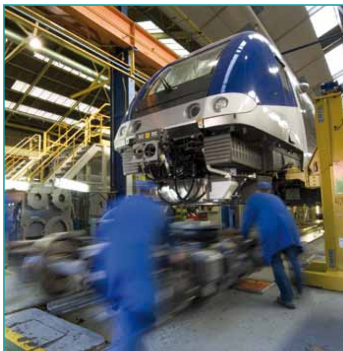
Assemblage de bogie du train régional AGV à Crespin- source www.bombardier.com
