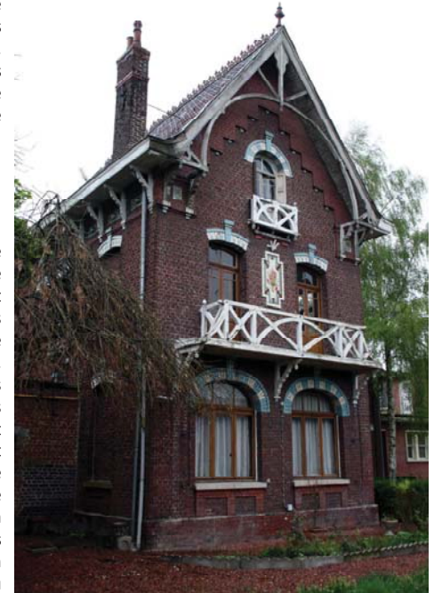
Façade principale de l'école ménagère avec le traitement pittoresque au niveau de la décoration : éléments en bois, céramique, fermes, combles en avancée...
