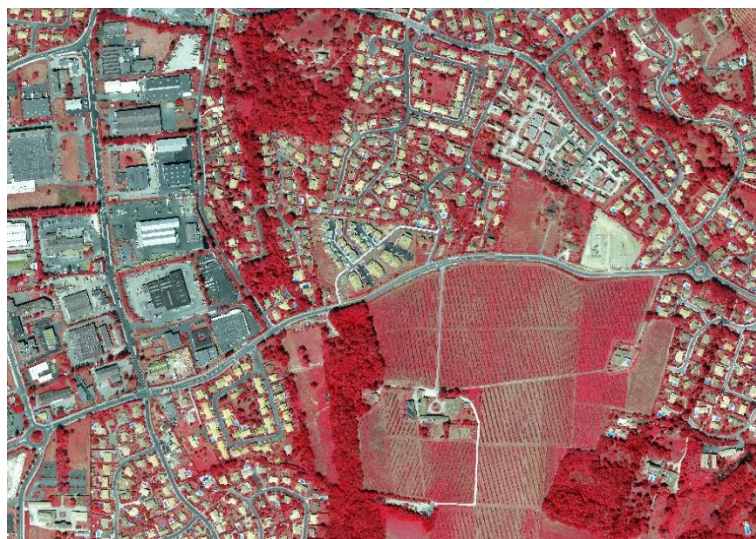
Figure 10 : image fausse couleur de la BD ortho IRC
