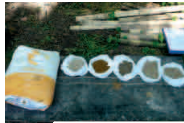
chaux et sables pour essais de teinte de mortier
