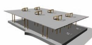
5 - pose de la couverture en panneaux sandwich
