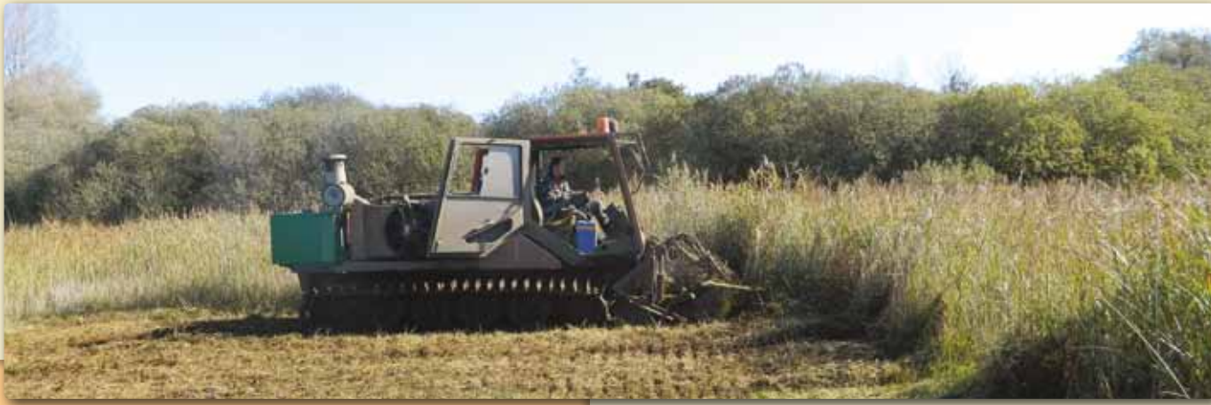
Photo 36 - La dameuse équipée d'un gyrobroyeur permet d'intervenir sur des secteurs très peu portants. (© GALLET B. - CEN Nord Pas-de-Calais)
