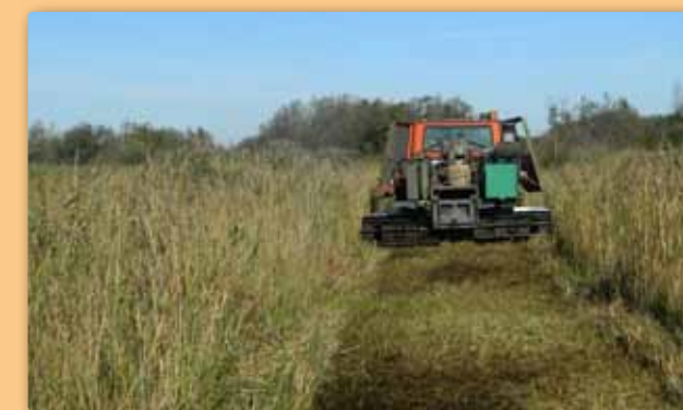
Photo 35 - La réalisation de layons est possible dans les secteurs les plus humides grâce à cette dameuse de piste de ski équipée d'un gyrobroyeur. (© GALLET B. - CEN Nord Pas-de-Calais)
