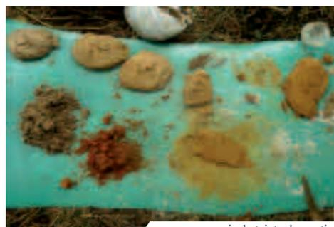
essais de teinte de mortier à partir de plusieurs échantillons de sable
