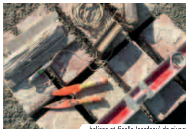
balises et ficelle (cordeau) de niveau
