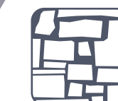
maçonnerie en pierre
