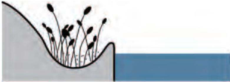
» Profil alternatif pour une voie navigable très fréquentée : après le mur de soutènement dur, le sol forme une cuvette de façon à créer une zone humide sur berge. Une liaison à la pièce d'eau est pratiquée à distance régulière.
