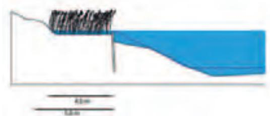
Niveau du sol  $-0,40\text{ m}$  à  $+0\text{ m}$  : derrière les palplanches se développe une zone marécageuse. Les palplanches sont nécessaires pour éviter l'érosion des berges
