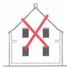
et non imiter une organisation et un format de fenêtre propres au corps de logis
