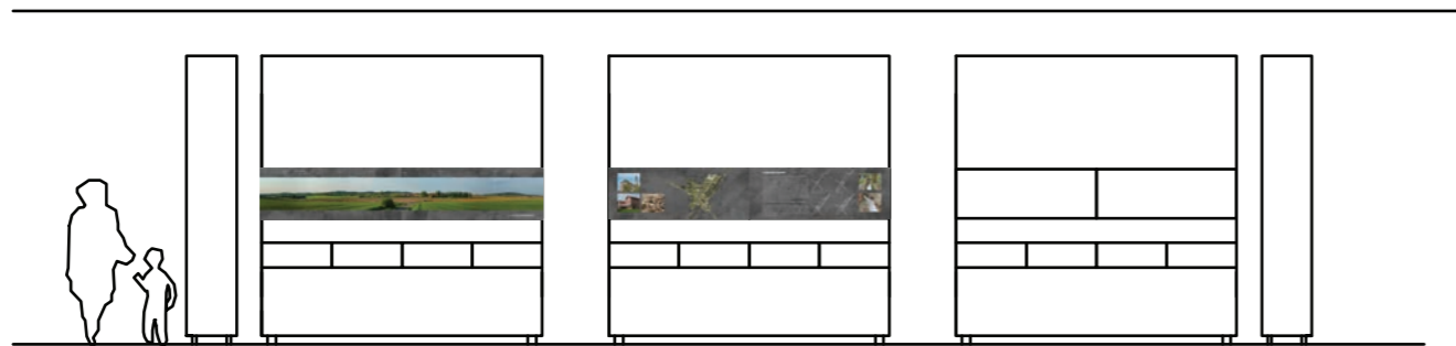
fig211_Elévation des modules supportant les panneaux d'acier Corten noirs dans le centre d'interprétation du mont
