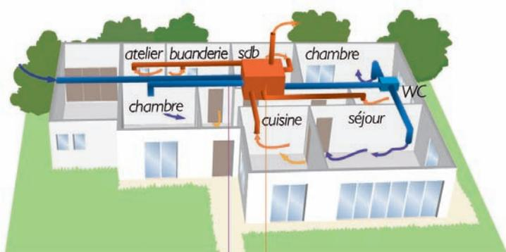
Circuit de soufflage qui distribue dans les pièces principales de l'air neuf réchauffé et filtré
