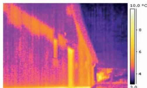
La thermographie infrarouge est une méthode de mesure de température de surface, par caméra. Cette méthode permet l'identification rapide des points critiques de la construction et constitue essentiellement un outil de contrôle.
