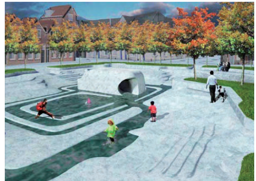
Fig. 73 Principe du «waterplein» ou place aquatique proposé par les urbanistes Florian Boer and Marco Vermeulen pour la récupération d'eaux de pluie à Rotterdam.
