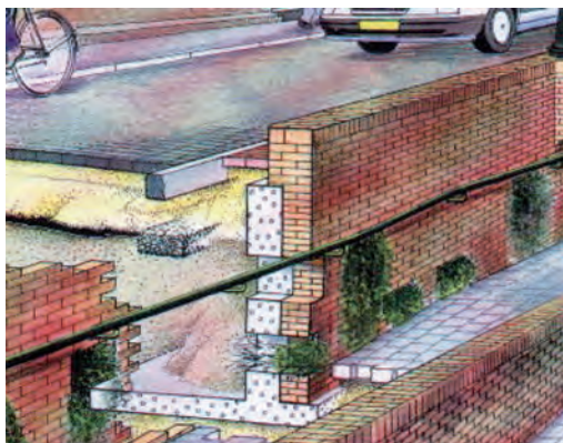
Fig. 126 Illustration du principe d'enracinement des plantes dans des trous ménagés dans la maçonnerie
