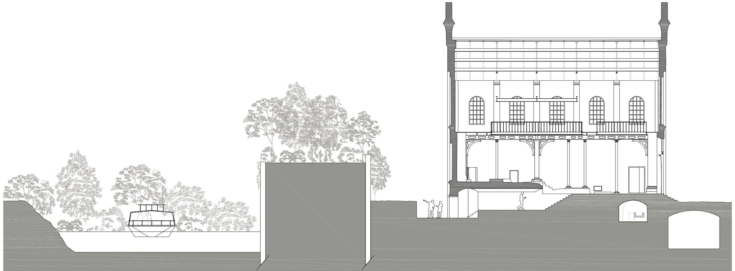
Les alcoves au sous-sol pourraient être recreusées jusqu'à atteindre le niveau du rez-de-chaussée. Cela permettrait de créer une continuité entre les deux niveaux, jusque là inexistante. Celle-ci pourrait être prolongée jusque l'extérieur en ménageant «une cour anglaise».
