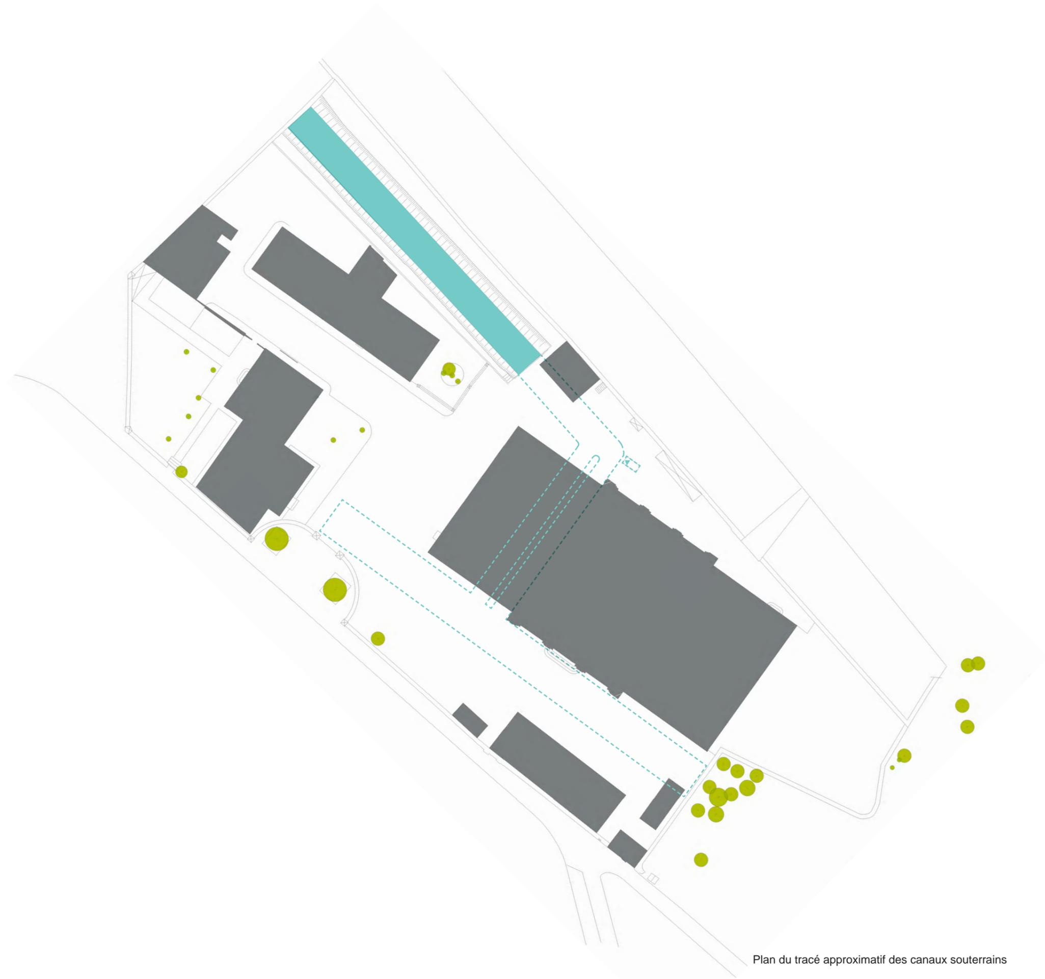
Plan du tracé approximatif des canaux souterrains
