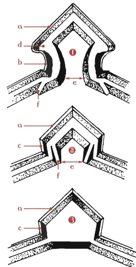
1 bastion à orillons 2 bastion creux 3 bastion plein a face b flanc concave c flanc droit d orillon e gorge f rampe.
