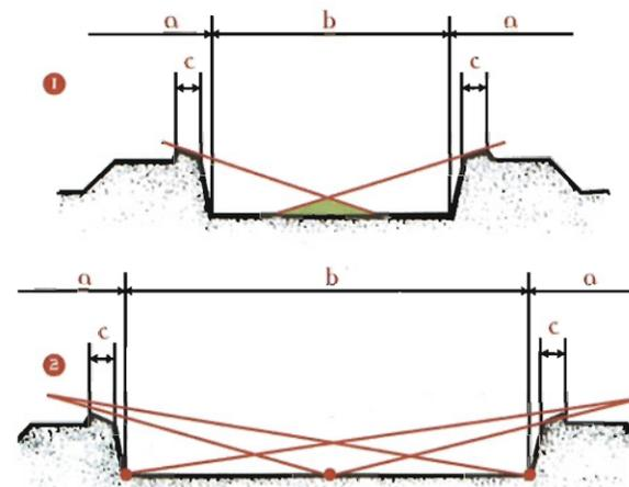
Le minimum de courtine : 1 la distance entre les deux bastions est insuffisante : un angle mort subsiste 2 la distance entre les deux bastions permet un tir sans angle mort
