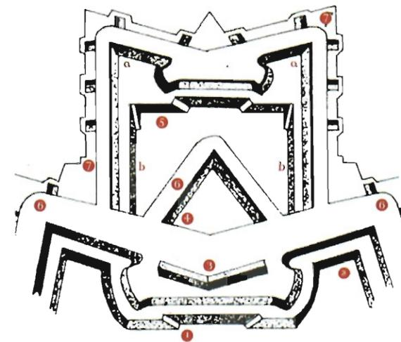
Les ouvrages extérieurs : 1 front bastionné 2 bastion à orillons 3 tenaille 4 demi-lune 5 ouvrage à cornes 6 fossé 7 chemin couvert a demi-bastion formant saillant de l'ouvrage à cornes b aile de l'ouvrage à cornes
