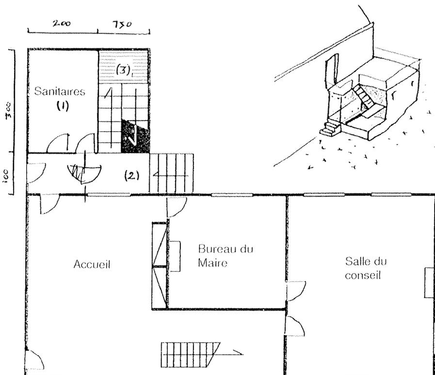
Rez de Chaussée : Aménagement d'un local de service comprenant des sanitaires répondant à la norme handicapés (1), un accès sur le jardin (2), un escalier à l'étage supérieur (3).
