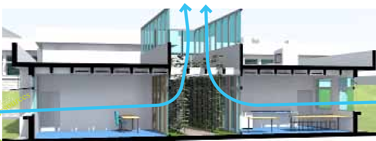
Patio : travail de percement sur le plancher à caissons et augmentation de la hauteur de tirage par des parois vitrées pour obtenir l'effet dépressionnaire nécessaire sans occulter la lumière.
